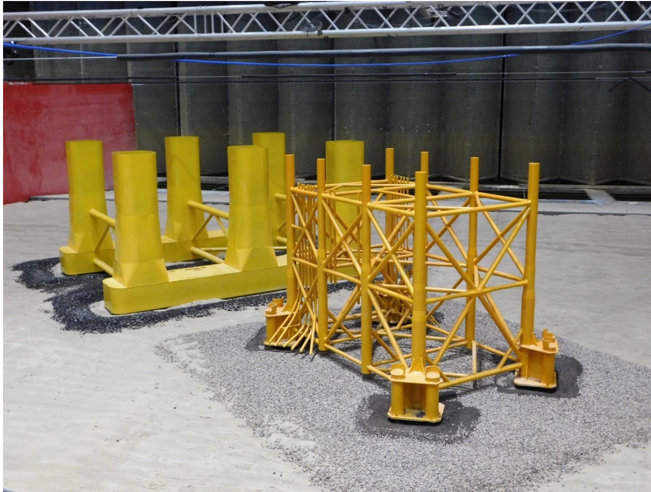
Modelo físico de lecho móvil de la erosión alrededor de la cimentación de plataformas Offshore.
