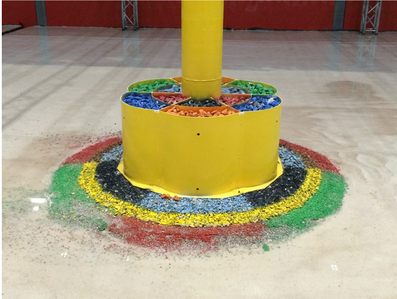
Modelo físico de lecho móvil de la erosión alrededor de la cimentación de una plataforma Offshore de gravedad
