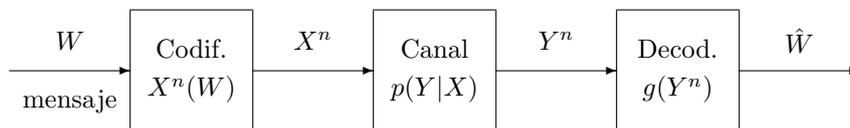
Figura 1: Notación. Se tiene  $X_i \in \mathcal{X}$ ,  $Y_i \in \mathcal{Y}$ ,  $i = 1, \dots, n$ .  $W \in J = \{1, 2, \dots, 2^{nR}\}$ , donde  $R$  es la tasa de transmisión.
