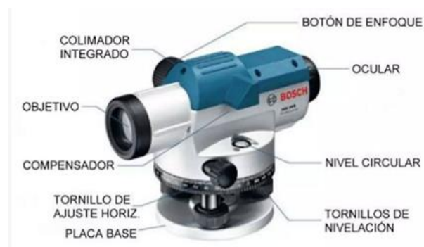
Ilustración 1. Componentes principales de un nivel óptico.
