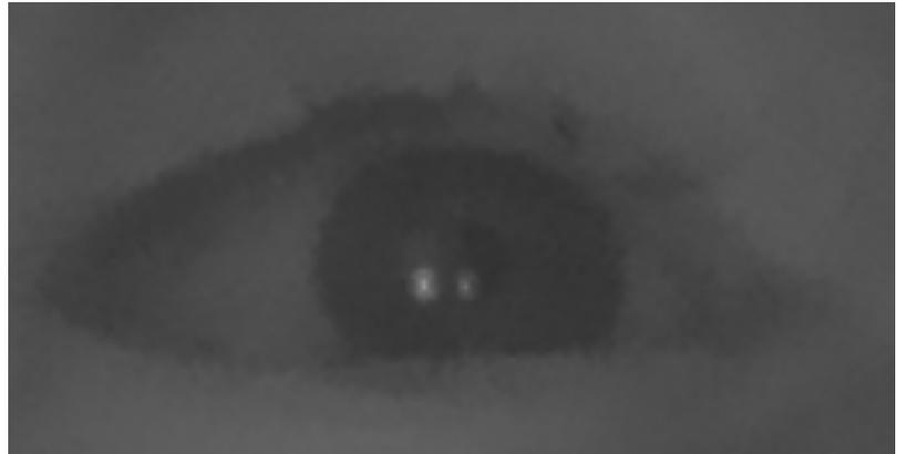
En esta base, las imágenes son recortes de ojos. Los glints se deben a la iluminación con los leds alejados de la cámara en un dispositivo como el de la siguiente figura:
