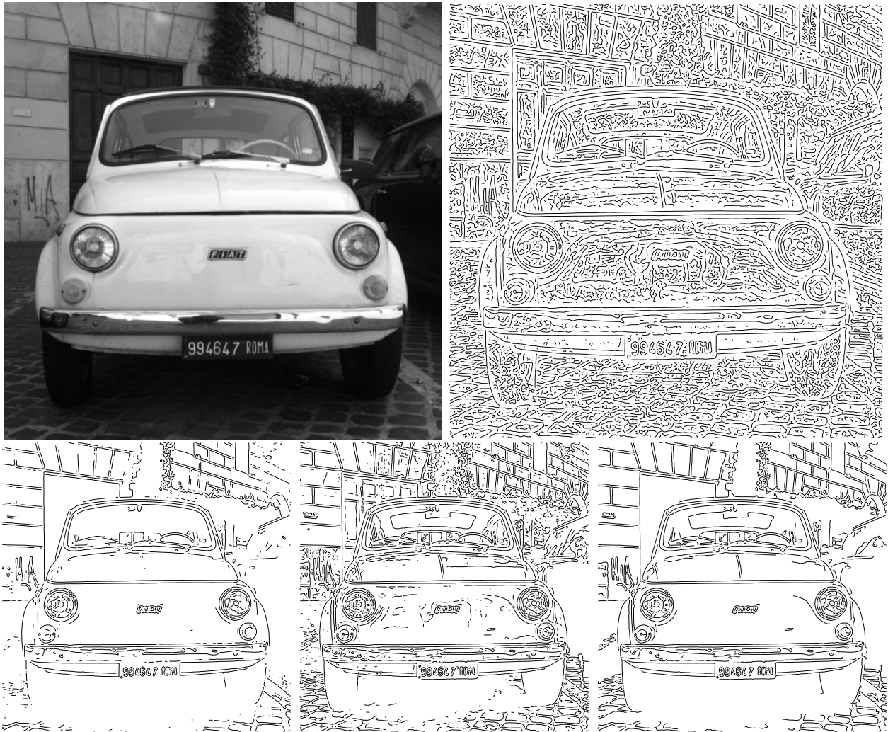
Figura 4: De izquierda a derecha y arriba a abajo: Una imagen de test en escala de grises, el resultado del filtrado de Sobel y la eliminación de no mínimos locales (sin umbralizar), los bordes que quedan luego de aplicar un umbral |\nabla| > 15 , los bordes que quedan luego de aplicar un umbral |\nabla| > 5 y los bordes que quedan luego de aplicar dos umbrales con histéresis U_{|\nabla|}^{inf} = 5 y U_{|\nabla|}^{sup} = 15 .
