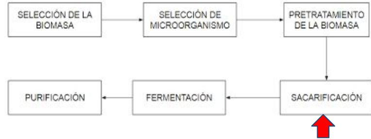
Es el paso para obtener los azúcares que se utilizan en la fermentación.
