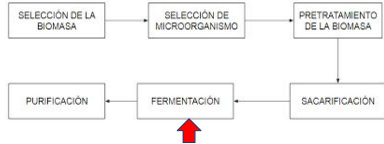
La fermentación para obtener ácido láctico puede ser realizada de forma discontinua, fedbatch, semicontinua o continua, bajo condiciones aeróbicas o anaeróbicas, con cultivos de microorganismos puros o mixtos, en solución o en estado sólido.
