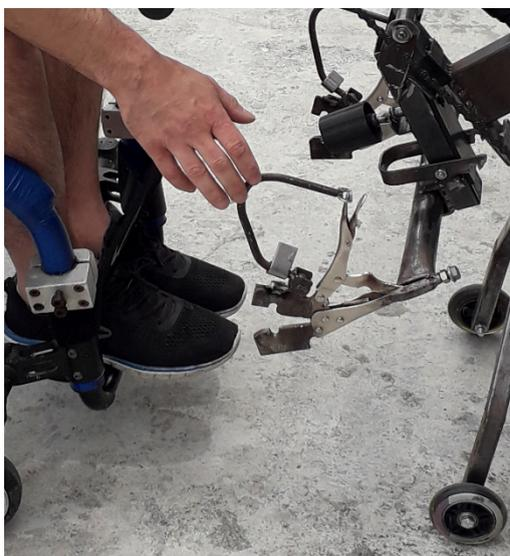
Cerrar las pinzas asegurándose de que han quedado sujetando todos los pernos (son 2 pernos por cada lado, 4 en total) y verificar que no exista movimiento relativo de las pinzas a la silla de ruedas, es decir, en este momento la unión de las pinzas y la silla de ruedas debe ser completamente rígida. De no ser así, abrir las pinzas, ajustarlas mediante el tornillo de regulación que poseen **(d)** y volver a cerrarlas asegurando los pernos.
