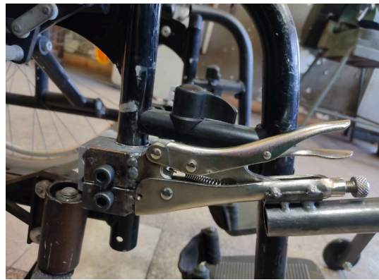
Figura 10: Cubos instalados en silla plegable (phi 28,6mm) y pinzas ya modificadas
