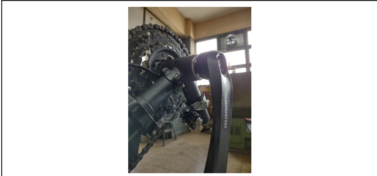
Figura 16: soporte para descarrilador delantero
