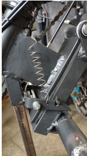
Figura 13: Vista detalle de automatismo de cierre mediante resorte y apertura mediante maroma
