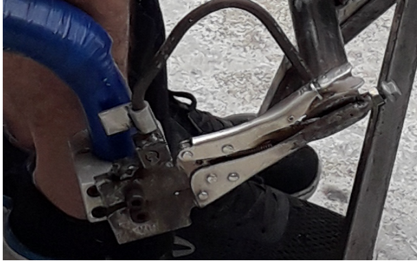
Figura 11: Cubos instalados en silla monoblock ( \phi 35 mm) y pinzas ya modificadas
