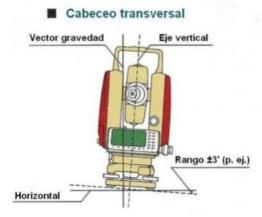
Calculan y aplican las correcciones de lectura H por error de colimación e inclinación del eje vertical y el de muñones
