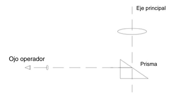
Este tipo de instrumento funciona de igual manera que las escuadras ópticas, usadas en la antigüedad para visualizar y replantear ángulos
