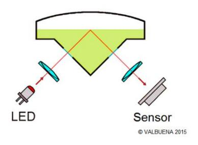
El compensador biaxial usa una reflexión interior superando el ángulo límite en la superficie horizontal de cambio de medio (aire/aceite de silicona). El haz láser del LED tras la reflexión llega al sensor (matriz CCD), detectándose la posición del punto donde impacta.
