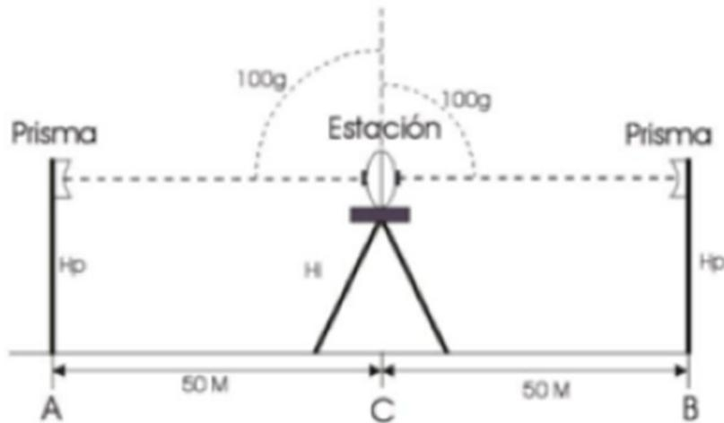
Se colocan tres puntos alineados, preferentemente sobre trípodes o bases fijas. Y sus respectivas bases nivelantes. Se coloca la estación en el punto A, y se mide la distancia A-B, luego se coloca la estación en el punto C y se miden las distancias C-A y C-B.
