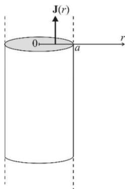
Figura 11: Cilindro con densidad de corriente no uniforme
