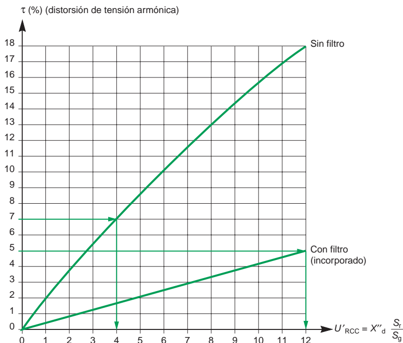
Fig. N11: Gráfico para calcular distorsión de armónica de tipo 3.
