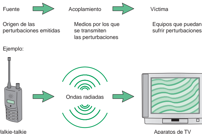
Fig. Ap18: Fenómeno de interferencia electromagnética.
