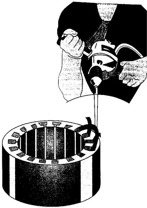
Fig. 9.31. Corte de bobinas mediante escoplo eléctrico.
