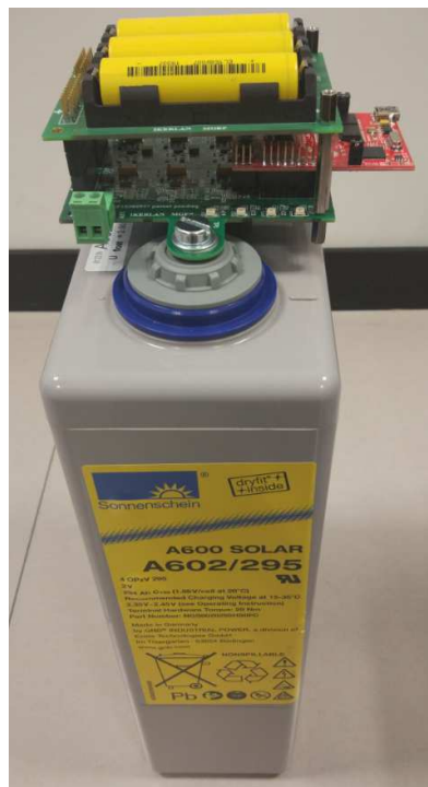
Instalación fotovoltaica aislada con baterías de plomo ácido, “Hybrid and Intelligent Energy Storage Systems in Standalone Photovoltaic Applications”, Iván Sanz PhD dissertation
