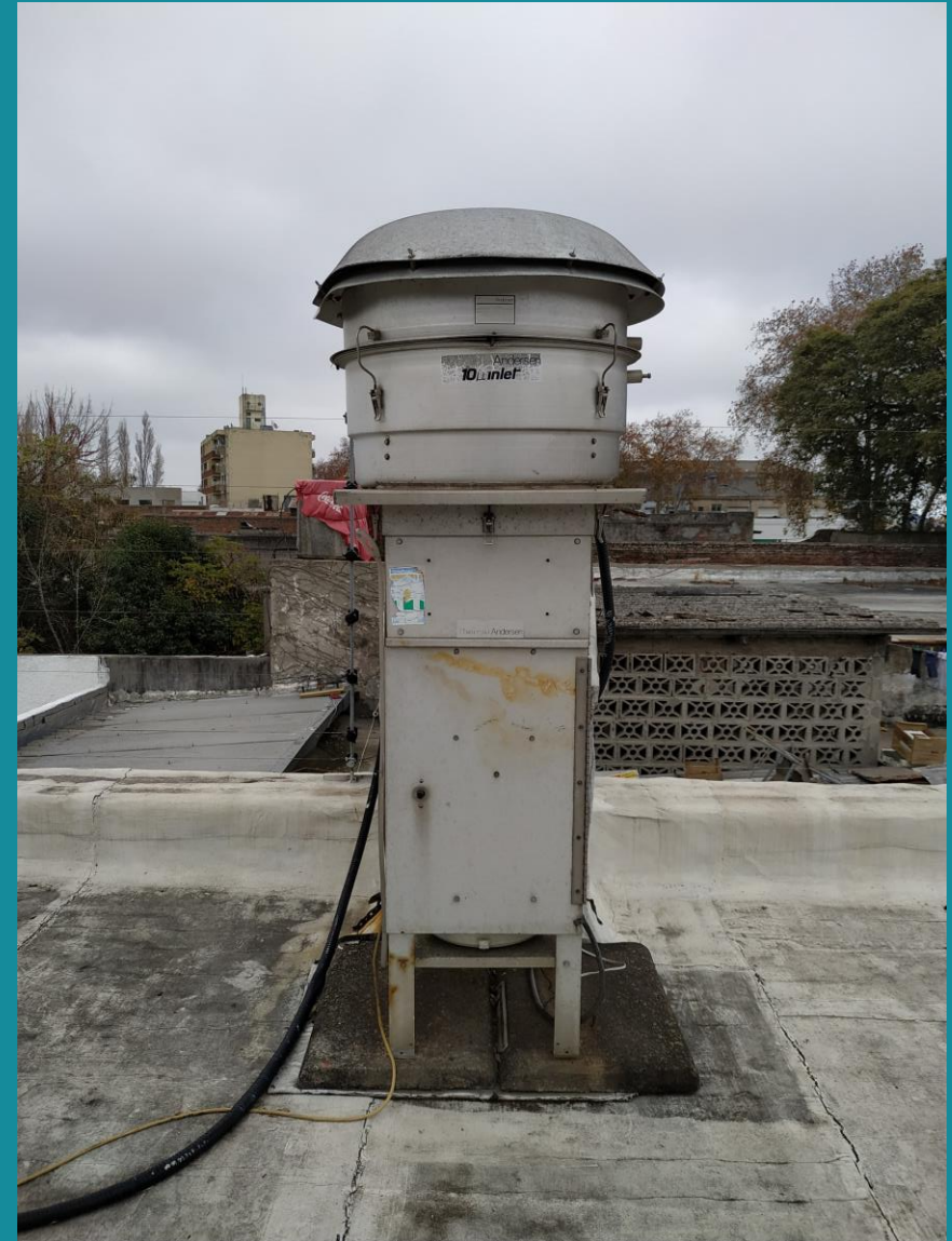
Equipo Hi-Vol configurado para PM_{10} (IM)
