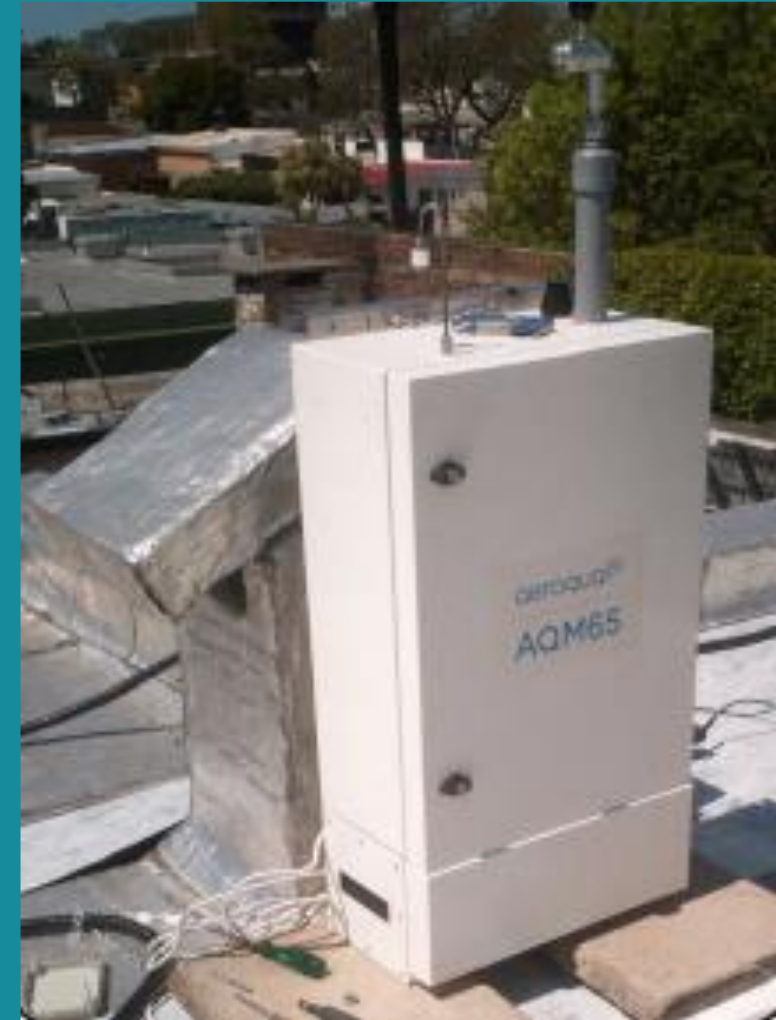
Equipo automático para la medición de la concentración de partículas y gases (IM)
