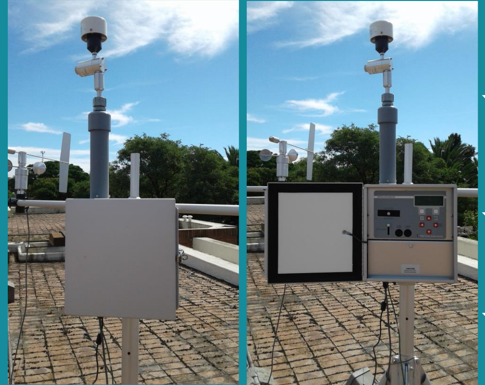
Monitoreo de calidad del aire en el barrio La Teja de Montevideo (ANII-FSE “Modelo integral de emisiones gaseosas y particuladas a la atmósfera: Análisis de una zona industrial y residencial de Montevideo”, IMFIA)
