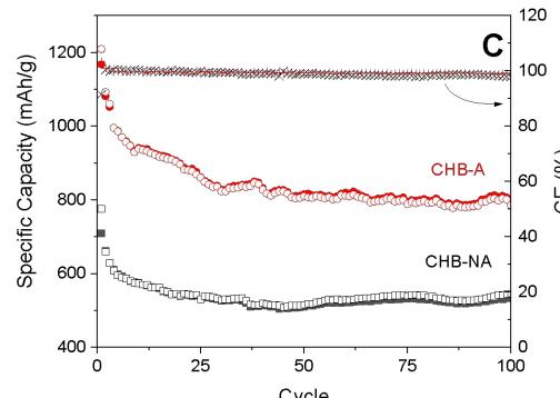
La estructura porosa generada en la activación mejora el rendimiento electroquímico del electodo.
