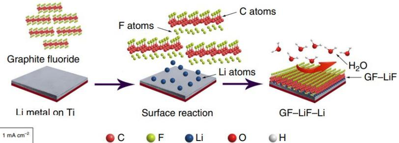
La SEI artificial se forma a partir de la reacción entre Grafito fluorado y litio metálico fundido.
