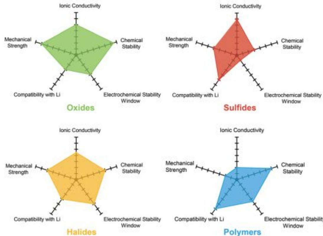
Los electrolitos sólidos pueden ser muy eficientes para mitigar la formación de dendritas debido a su dureza mecánica y altos números de transferencia de Li<sup>+</sup>.
