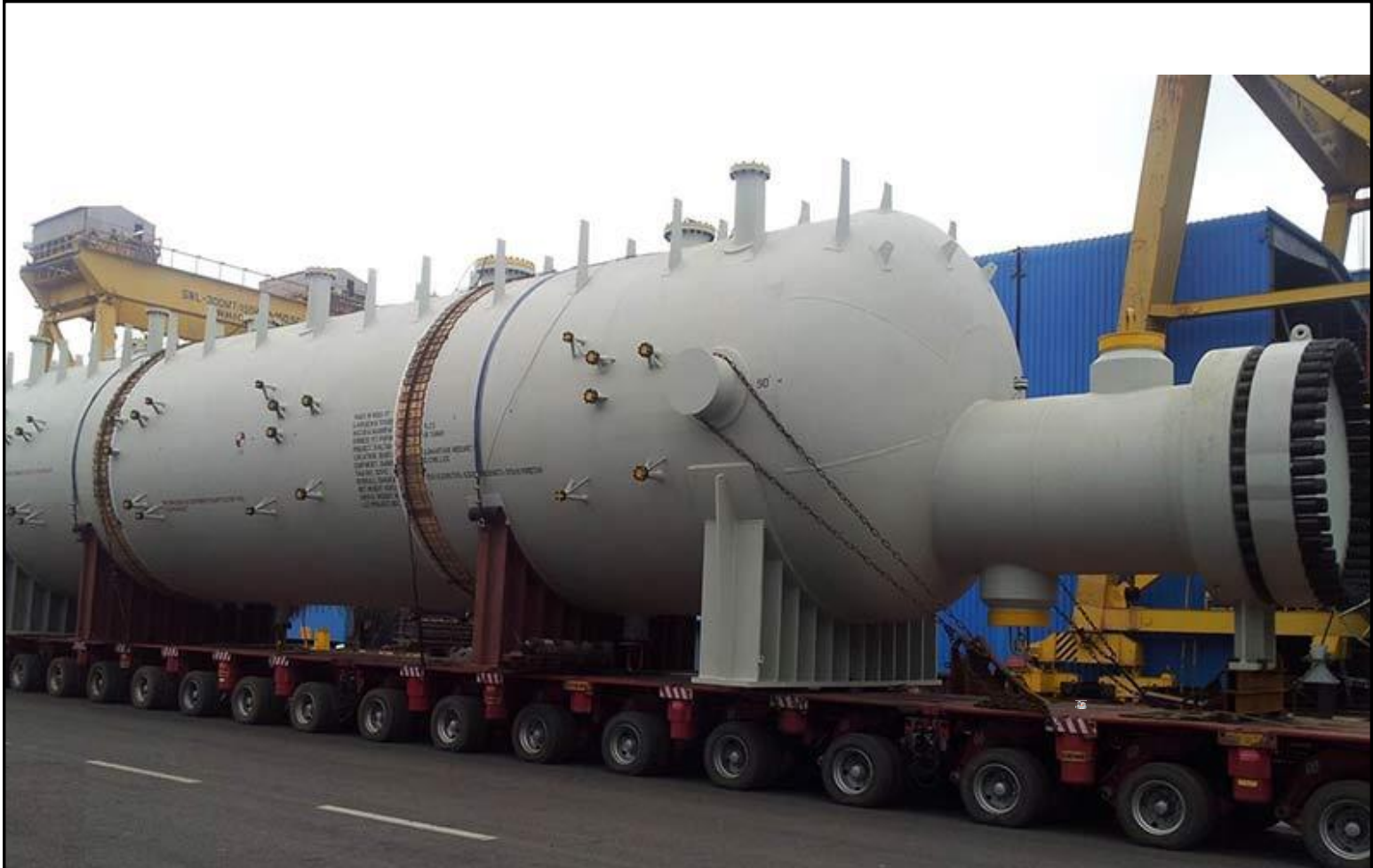
Intercambiador de calor para el reciclo de la síntesis de amoníaco
