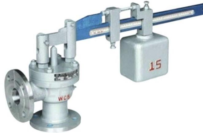
Antiguamente se usaban válvulas donde el elemento de cierre consistía en una palanca con pesas. Cuando la presión de vapor supera la presión de seteo la fuerza ejercida es suficiente para que la válvula abra.
