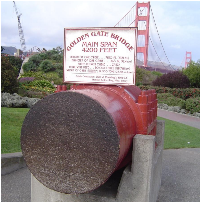
Cable principal del Puente de San Francisco - 27572 Alambres
