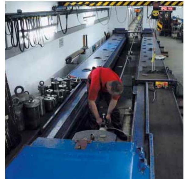
Vorbereitung zum Vorrecken eines Seiles Preparation of prestretching for a cable
