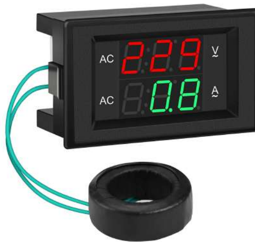
Figura 2.4 Instrumento de tablero para la medida de CA. Note que el amperímetro tiene asociado un transformador de corriente.
