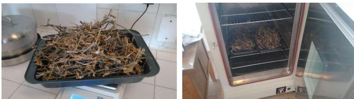
Figura 1.2: Ensayo de Humedad Total de rastrojo de Soja
