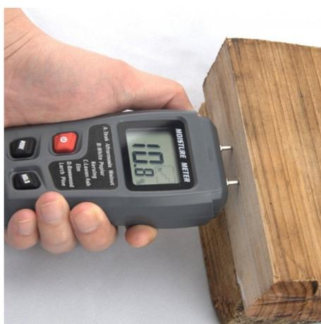
Figura 1.3: Sensor de humedad *in situ*.
