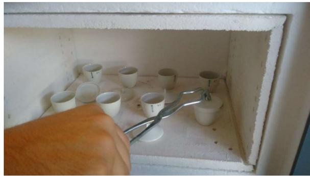
Figura 1.4: Ensayo análisis próximo
