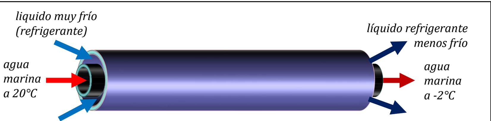
Dibujo esquemático: Intercambiador de calor de tubos concéntricos
