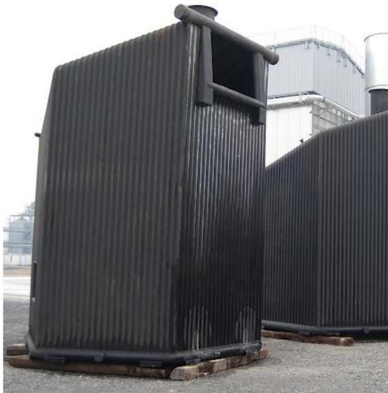
El Gasógeno incluido en esta propuesta es de tipo vertical, de tiro ascendente. Está conformado por dos colectores y una pared tubular tipo membrana, con un techo de las mismas características. Los colectores está comunicados a la caldera por caños montantes y bajantes que aseguran la circulación del agua a través de los mismos, permitiendo un mejor aprovechamiento del calor generado durante el proceso de gasificación.
