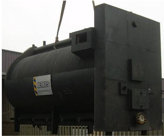
La Cámara Torsional es el "quemador" dónde se produce la combustión del gas proveniente del Gasógeno. Dicho gas ingresa a la Cámara Torsional a través de un ducto de conexión. El aire de combustión proveniente del ventilador secundario entra al pleno conformado por la camisa exterior de la cámara.
