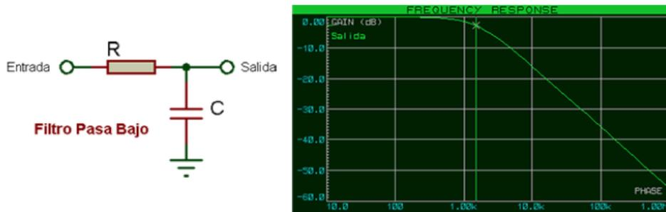
El microcontrolador alimentará el circuito R-C con una señal PWM de frecuencia mucho mayor a la frecuencia de corte del filtro. Dado que el sistema sobre el que se trabaja es un pasabajos natural, la señal a la entrada del mismo será equivalente a un voltaje en continua.
