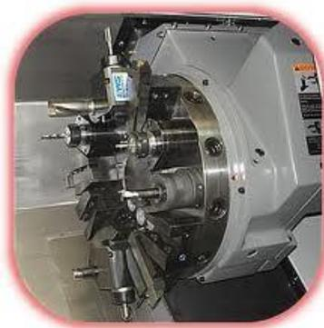
**Fig. 7. Porta herramienta de un Torno Revolver**
