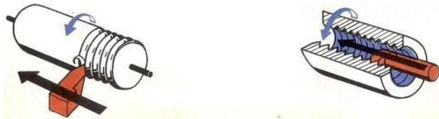
**Fig.23. Roscado en el Torno**
