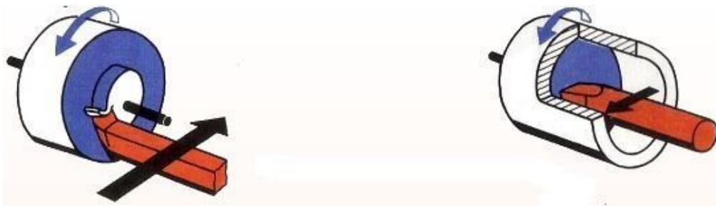
**Fig. 11. Esquema funcional de refrentado**
