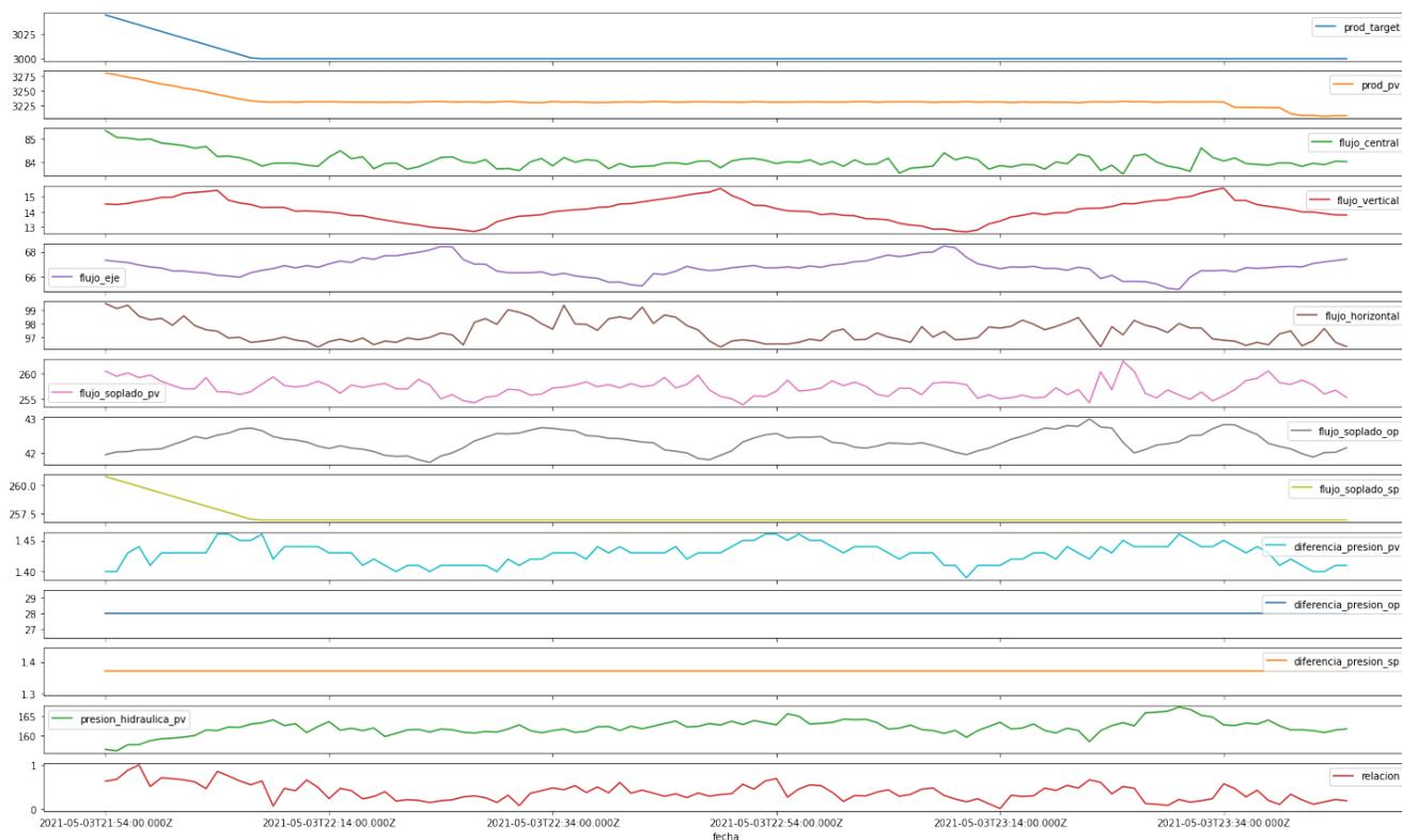
Figura 5.13: Flujos de filtrado y diferencia de presión cuando el flujo horizontal es menor a 100 y la producción 3200-3500.
