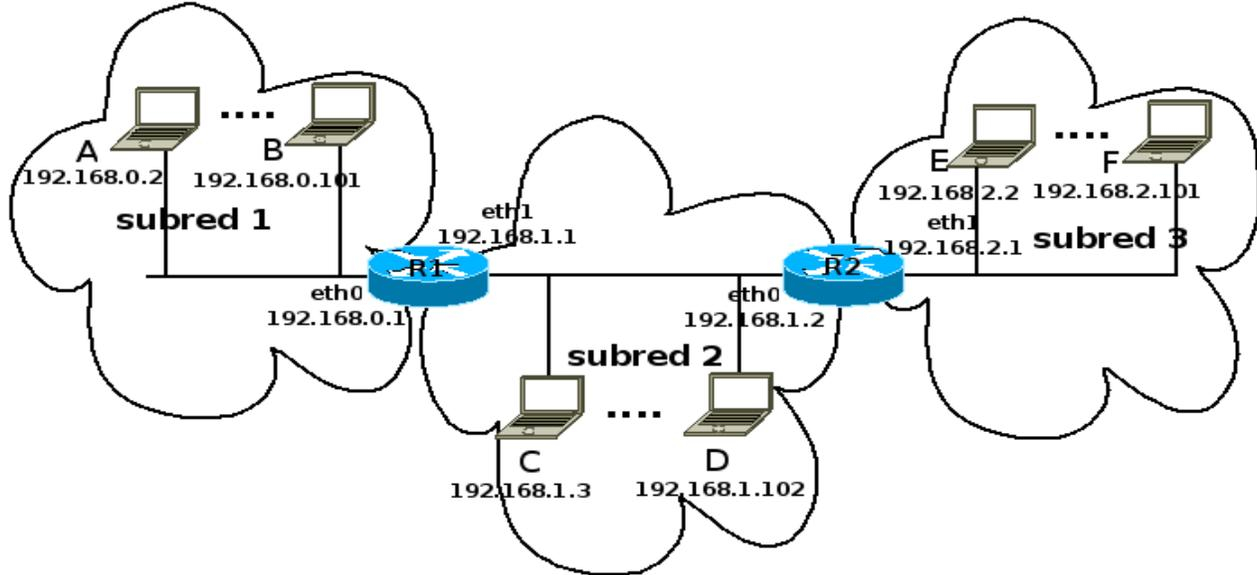
En la misma se indican los nodos conectados en cada subred así como la dirección IP de cada interfaz. Para su direccionamiento se asignó una red /24 a cada una de las subredes como se presenta en la figura, y se supone la existencia de 100 hosts en cada subred. El enrutamiento es estático.
