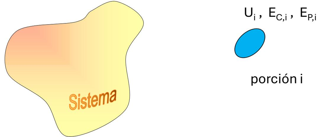
Energía interna y externa que transporta cada porción de masa intercambiada con el entorno,  $E_i = U_i + E_{C,i} + E_{P,i}$
