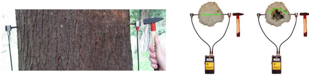
Figura A1.3. Ejemplo de uso del Fakopp.
