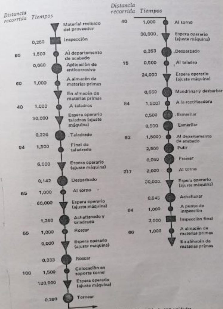
Fig. 3.7 Diagrama de flujo del proceso de fabricación del asiento de válvula partiendo del montaje de válvula
