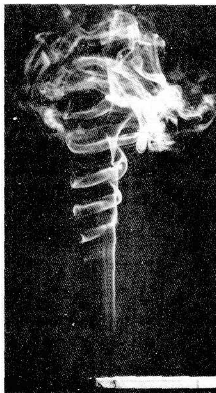
Figura 21 El humo que asciende tiene primeramente un flujo estacionario, pero no tarda en convertirse en turbulento.
