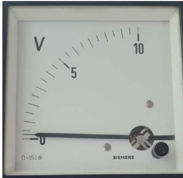
Figura 1.5. Voltímetro analógico Siemens.
