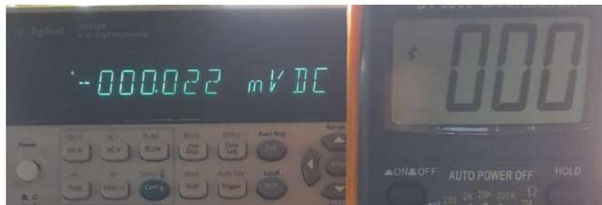
Figura 1.6. Izquierda multímetro de banco con salida 7 segmentos, derecha multímetro de mano con salida LCD.
