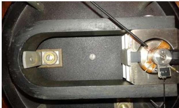
Figura 1.4. Mecanismo de imán permanente y bobina móvil
