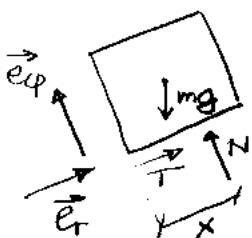
$$\begin{aligned} \text{1º cardinal: } \vec{M}_G &= \vec{R}^{(\text{ext})} \\ \vec{r}_G &= (l+a)\vec{e}_r + a\vec{e}_\phi \\ \vec{v}_G &= (l+a)\omega\vec{e}_\phi - a\omega\vec{e}_r \\ \vec{a}_G &= -(l+a)\omega^2\vec{e}_r - a\omega^2\vec{e}_\phi \end{aligned}$$
