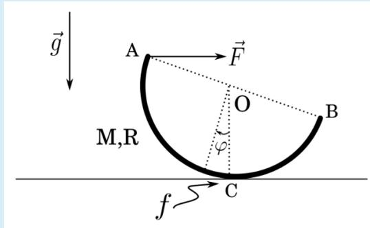
Un semicirculo homogéneo de masa  $M$  y radio  $R$ , contenido en un plano vertical, está apoyado sobre un piso horizontal. El contacto entre el semicirculo y el piso es rugoso con coeficiente de rozamiento estático y dinámico  $f$ . Además del peso actúa una fuerza  $F$  constante y horizontal que se aplica en el extremo  $A$  del semicirculo, según indica la figura. Inicialmente el semicirculo se encuentra en reposo con su centro de masa en su posición inferior.
