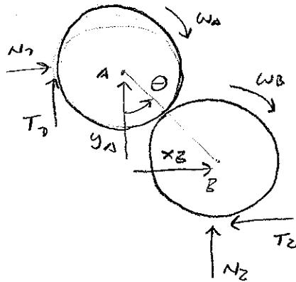
2) rotación sin deslizamiento:  $\dot{\theta}_A = -\omega_A R$
