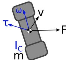
$$K = \frac{1}{2} \omega^T I_c \omega + \frac{1}{2} m v^2$$
