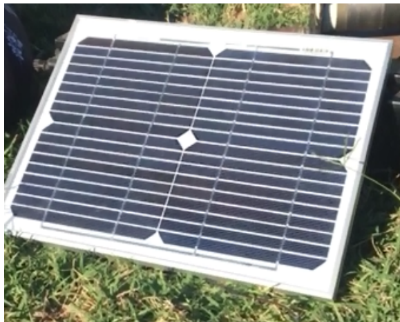
(a) Panel fotovoltaico.
