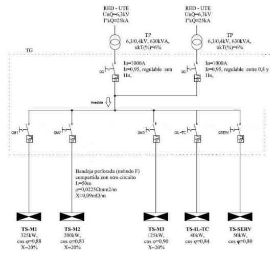
Los tableros TS-M1, TS-M2 y el TS-M3 son tableros de motores, el tablero TS-IL-TC es de iluminación y tomas y el TS-SERV es de servicios.
