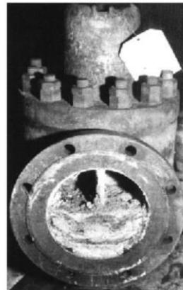
Figura 42—Depósitos de azufre en cuerpo de válvula
