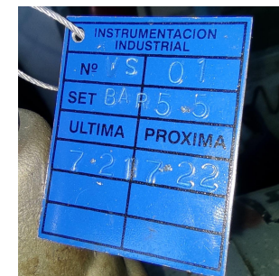
Placas de calibración de válvulas de seguridad. Autor: URSEA.
