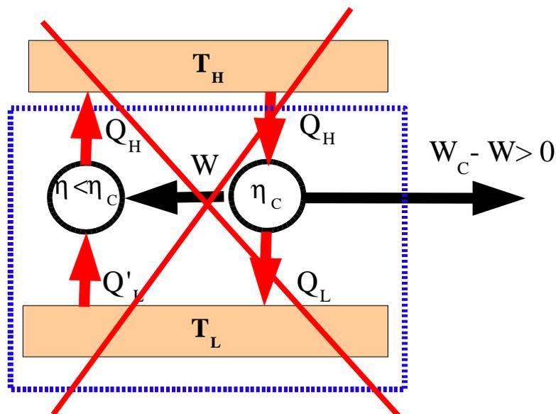
Por el contrario, si la eficiencia  $\eta = \eta_c$ , entonces  $W = W_c$ , no se produce trabajo en el proceso y la violación de la Segunda ley no tiene lugar.
