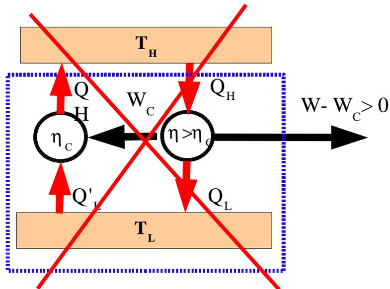
Puedo usar el trabajo  $W > W_c$  generado por la máquina mas eficiente para mover la bomba de calor y todavía me sobra trabajo.
