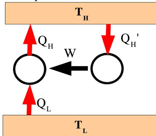
**B)** Supongamos que el postulado de Clausius es falso. Entonces, existe una bomba de calor que no consume trabajo. Esta bomba puede ser usada para devolver el calor que una máquina térmica vierte a la reserva de baja a la reserva de alta. Por lo tanto, el dispositivo conjunto generaría trabajo a partir de una sola fuente de calor, violando el postulado de Kelvin.
