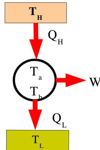
Aumentar  $T_a$  y reducir  $T_b$  mejora la eficiencia de la máquina pero perjudica la transferencia de calor, haciéndola más lenta. Por otro lado, reducir  $T_a$  y aumentar  $T_b$  mejora la transferencia de calor pero empeora la eficiencia de Carnot de la máquina.
