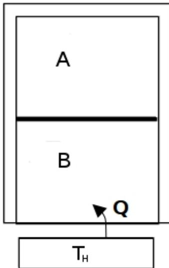
La figura muestra un recinto cilíndrico de volumen total  $V_T=2 \text{ m}^3$  y sección  $A_p=0,1 \text{ m}^2$  con todas las paredes adiabáticas excepto la inferior. Un pistón adiabático de masa  $m_p=50 \text{ kg}$  y espesor despreciable separa al recinto en dos compartimientos **A** y **B** que contienen respectivamente un gas ideal monoatómico y otro diatómico.
