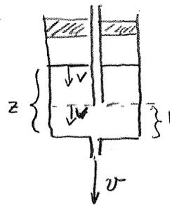
Por continuidad (despreciando el área del tubo)  $A \cdot V = a \cdot v \Rightarrow 2gh + \left(\frac{a}{A} v\right)^2 = v^2$
