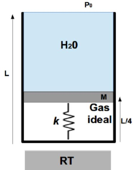
Luego se quita la aislación de la pared inferior del cilindro y el sistema intercambia calor con una reserva térmica a temperatura  $T = 1500$  K. El pistón empieza a subir y la transferencia de calor continua hasta que el pistón alcanza la altura  $L$  y toda el agua desborda.
