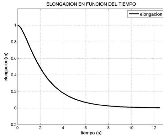
Figura 2: Gráfica de la elongación en función del tiempo para el caso sobreamortiguado.
