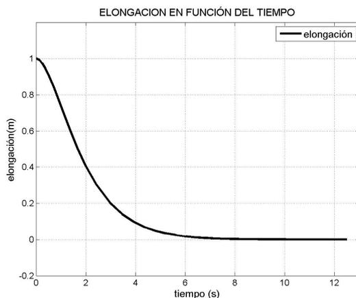
Figura 4: Gráfica de la elongación en función del tiempo para el caso de amortiguamiento crítico.
