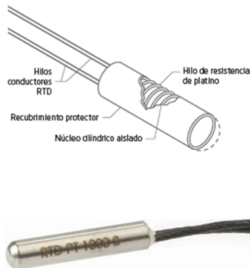
Figura 1: Esquema de la estructura de un sensor de temperatura RTD e imagen digital de un dispositivo comercial.
