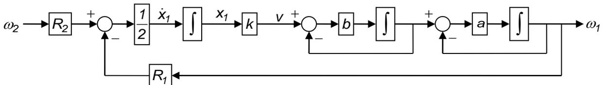
Se trata de un sistema de control *integral* de velocidad. La realimentación se produce en la parte la de cinta acumulada entre el tambor y los rodillos. La función de transferencia del sistema realimentado es:
