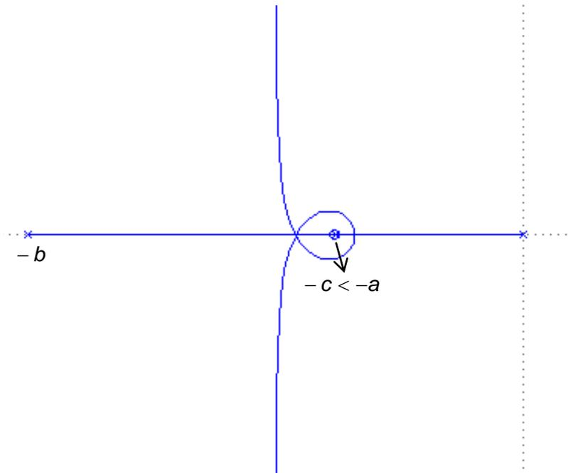
En cualquier caso, para  $k$  suficientemente grande se puede lograr que todos los polos del sistema tengan parte real menor que  $-a$ .
