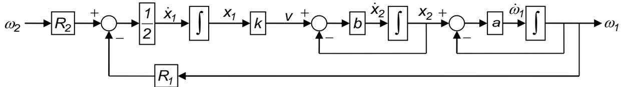
A partir del diagrama de bloques anterior se obtiene la siguiente representación en variables de estado, donde  $\omega_2$  es la entrada,  $\omega_1$  es la salida, y  $[x_1 \ x_2 \ \omega_1]^T$  es el vector de estado:
