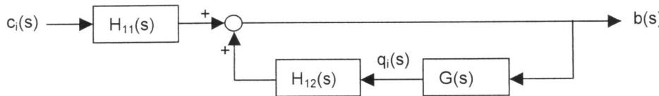
$$\text{Función de transferencia en lazo cerrado: } H_{LC}(s) = \frac{b(s)}{c_i(s)} = \frac{K_1}{(s + \omega_1)(s + \omega_2 + K_2 G(s))} .$$
