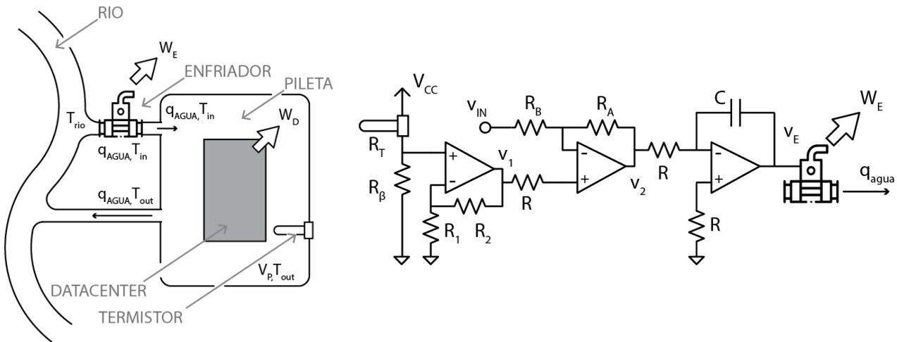
Figura 2a. Sistema de enfriamiento con el intercambiador de calor instalado. Figura 2b, sistema de control del intercambiador de calor.
