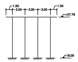
d) Si durante la ejecución del puente se detectara que el nivel de cimentación del pórtico P2 se debe modificar a +20.05, ¿cómo afecta a las acciones horizontales longitudinales esta modificación en cada uno de los pórticos?.
