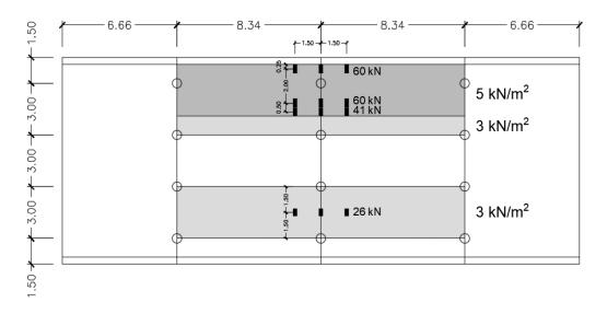
Máximo momento flector positivo en la viga dintel entre los dos pilares centrales del pórtico interior P2.
