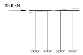
Fd = 0.25 \* Frenado = 0.25 \* 360 kN = 90 kN que se reparte en los tres pórticos interiores.
